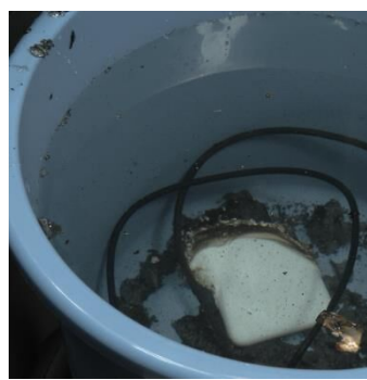
消火後に水没させる様子 （再現実験）
