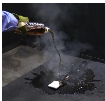
大量の水で消火している様子 （再現実験）
