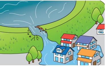
また、流木などによりため池の洪水吐がふさがれてしまうと、堤防からの越流により堤防が侵食され、決壊に至る恐れがさらに高まります。
